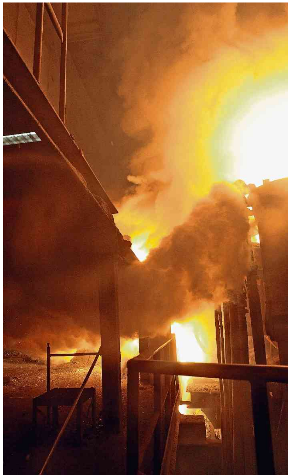
Beim Stahlkochen bleibt glühend heisse Schlacke zurück. Diese muss in einem speziellen Verfahren abgekühlt werden.
